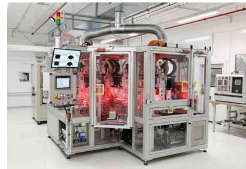
Ein Automat stapelt Elektroden-Sheets automatisch übereinander
