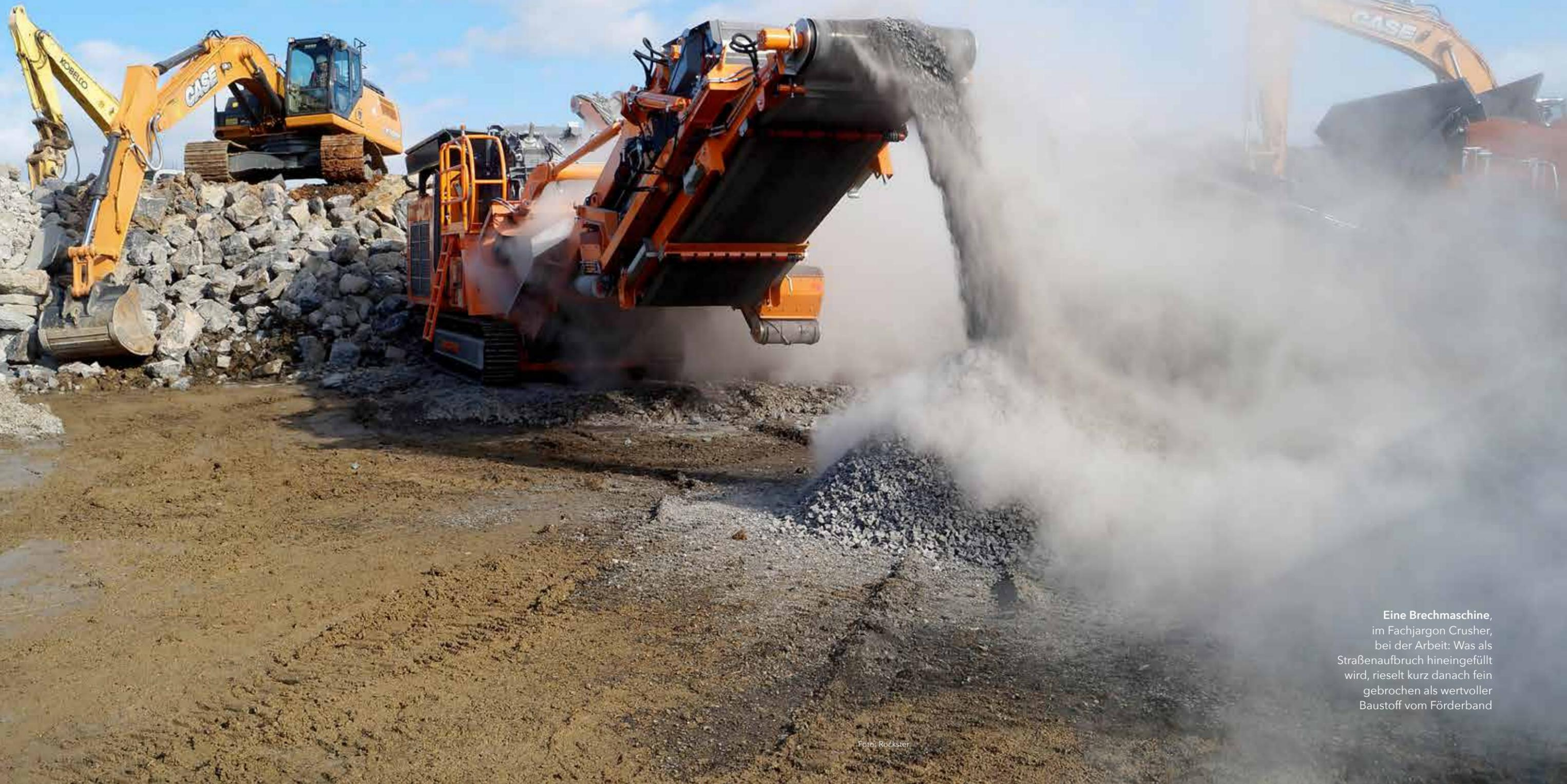
Eine Brechmaschine, im Fachjargon Crusher, bei der Arbeit: Was als Straßenaufbruch hineingefüllt wird, rieselt kurz danach fein gebrochen als wertvoller Baustoff vom Förderband
